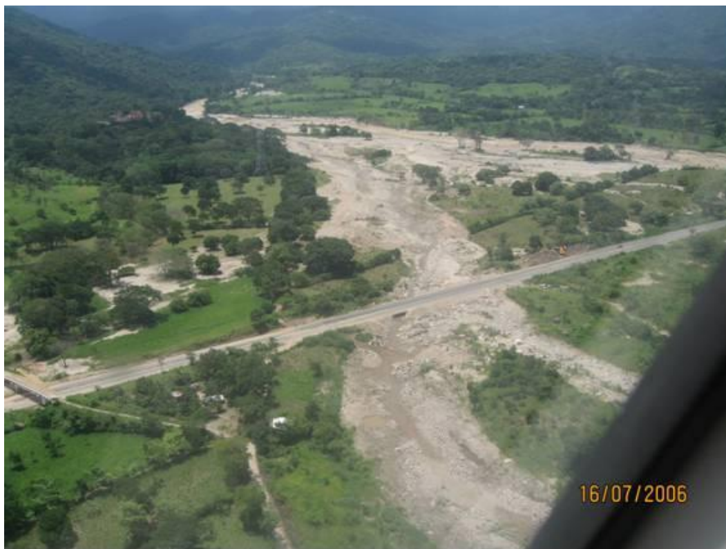
Fotografía 2.30.- Cauce del Río Huixtla. Observe el brazo que abrió a su paso por el libramiento de la ciudad de Huixtla.
