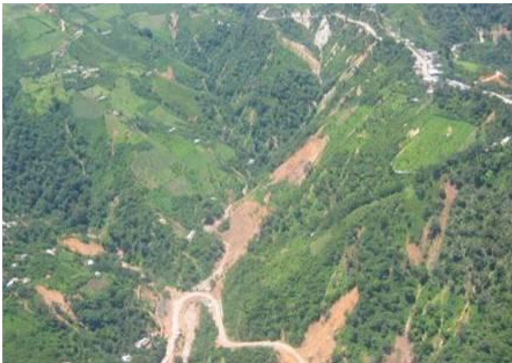
Fotografía 2.20.- Vista panorámica del parteaguas de la subcuenca del río Huixtla. Observe la gran cantidad de deslizamientos y flujos de material en el lugar.
