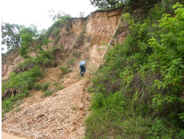
Fotografía 53. Nótese el deslizamiento de material sobre los planos de fracturamiento, en las cercanías del poblado Villahermosa, municipio de Villaflores (TUX063).
